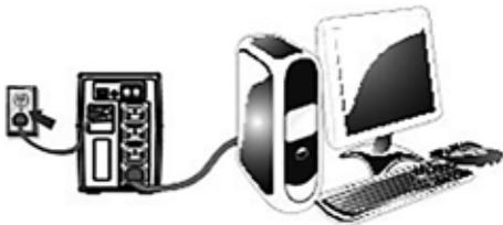
Schließen Sie die USV an die Netzversorgung an. Danach schließen Sie dann jeweils ein computerbezogenes Gerät (Verbraucher) an eine der Ausgangssteckdosen der Rückseite der USV an. Beachten Sie beim Anschluss der Verbraucher deren maximale Last. Achten Sie darauf, dass die Verbraucher ausgeschaltet sind.
