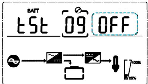
Dies ist die Einführung in die Einstellung des Batterieselbsttests.
