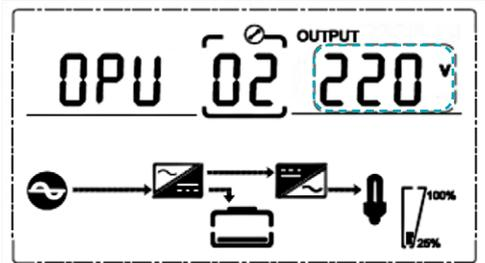
Wenn Sie unter der Moduseinstellung die Taste DOWN oder unter der Frequenzeinstellung die Taste UP drücken, gelangen Sie zur Einstellung der Ausgangsspannung. Um die Einstellung der Ausgangsspannung zu wählen gehen Sie wie folgt vor:
