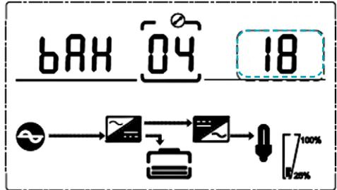
Wenn Sie unter der Frequenzeinstellung die Taste DOWN oder unter der Einstellung der Batteriemenge die Taste UP drücken, gelangen Sie zur Einstellung der Batteriekapazität. Die Einstellung der Batteriekapazität können Sie wie folgt wählen:
