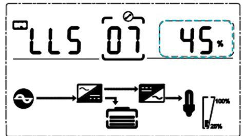
Wenn Sie unter der Einstellung für den oberen Grenzwert der Bypass-Spannung nach unten drücken oder wenn Sie unter der Einstellung für die Stummschaltung des Summers nach oben drücken, wird die Einstellung für den unteren Grenzwert des Bypasses aktiviert. Die Einstellung des unteren Bypass-Grenzwerts können Sie wie folgt wählen:
