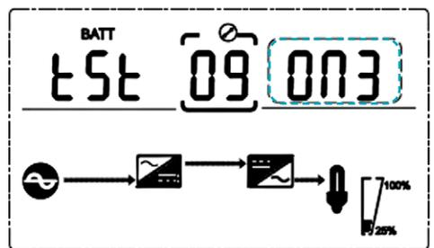
Wenn Sie ON3 wählen, kann die USV alle 30 Tage automatisch in den Batteriemodus wechseln. Die Batterie-Selbsttestzeit ist EOD (End Of Discharge).
