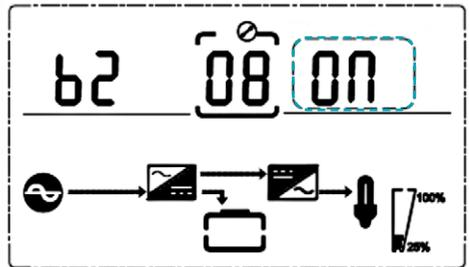
Drücken Sie DOWN unter der Einstellung der Bypass-Spannungsuntergrenze oder drücken Sie UP unter der Einstellung des Batterieselbsttests, um die Einstellung des Summers aufzurufen. Jetzt blinkt der Einstellungsstatus wie in der Abbildung gezeigt. Die Auswahl umfasst ON und OFF.
