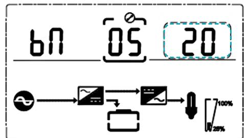
Wenn Sie unter der Einstellung für die Batteriekapazität die Taste DOWN oder unter der Einstellung für die Bypass-Spannungsgrenze die Taste UP drücken, gelangen Sie zur Einstellung für die Batteriemenge.
