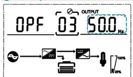
Wenn Sie bei der Einstellung der Ausgangsspannung die Taste DOWN oder bei der Einstellung der Batteriekapazität die Taste UP drücken, gelangen Sie zur Frequenzeinstellung.
