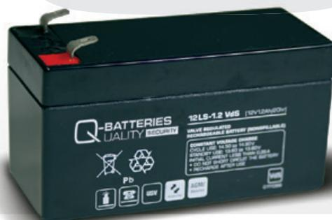
Bei der Q-Batteries LS-Serie handelt es sich um ventilregulierte und wartungsfreie AGM-Akkus (Absorbent Glass Mat-Technologie), die besonders für Stand-by-Anwendungen, wie zum Beispiel in der Sicherheitstechnik, Brandmeldetechnik, USV und UPS, entwickelt wurden.
