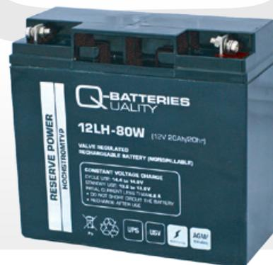
Bei den Q-Batteries Hochstromtypen handelt es sich um AGM-Akkus (Blei-Vlies-Technologie), die speziell für Hochstromanwendungen konzipiert wurden. Aufgrund der größeren Oberfläche der Bleiplatten, kann kurzfristig ein sehr hoher Strom, beispielsweise für USV-Anlagen bereitgestellt werden.
