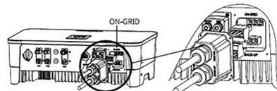
④ Montierten AC-Stecker in den AC-Anschluss des Wechselrichters stecken
