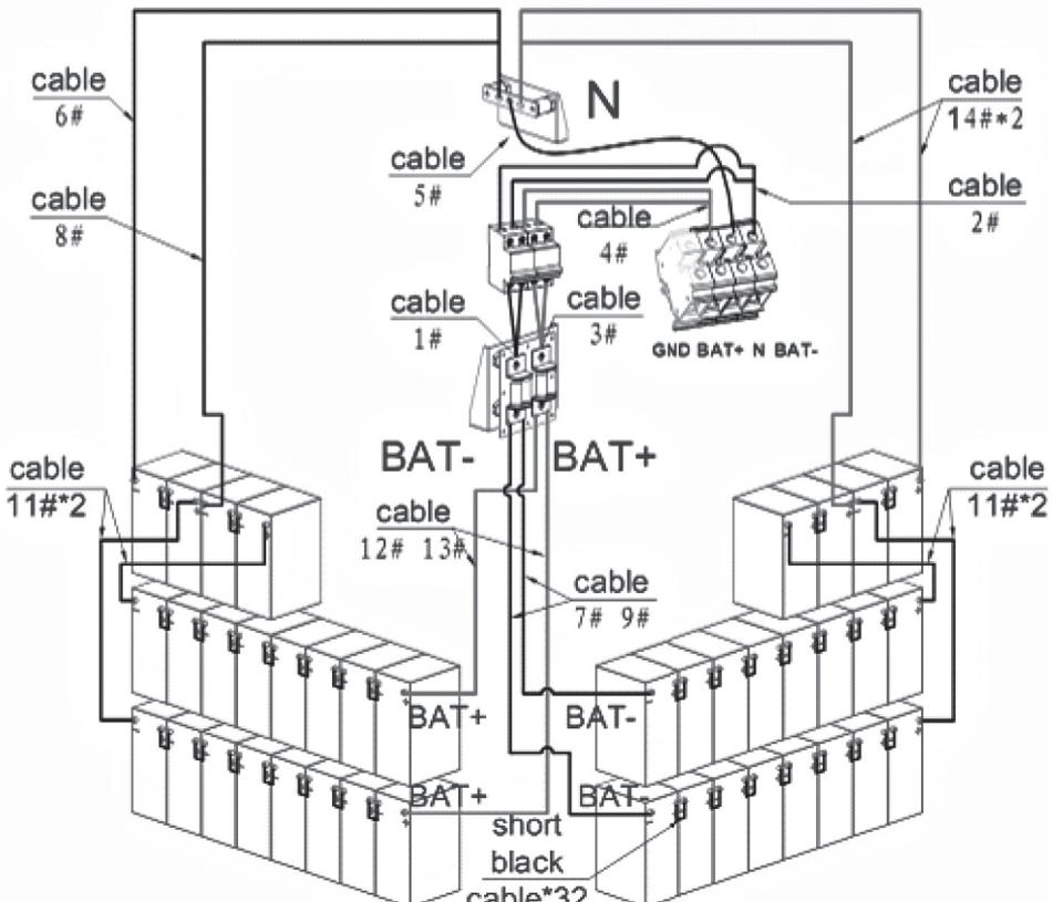
**Verdrahtungsplan für die Installation von 40 Stück Batterien**
