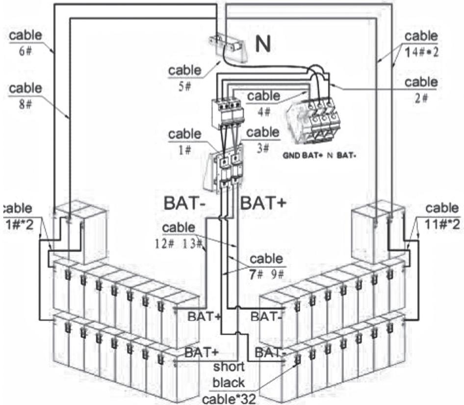
**Verdrahtungsplan für die Installation von 36 Stück Batterien**
